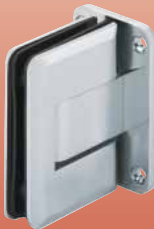
Pendeltürband T-Motion Art.-Nr. 6856 GW OF 20 (mattnickel) für Türgewichte bis 60 kg per Paar. 90° Feststellung, pneumatische Pendel- funktion bereits ab 70°. Justierbarer Endanschlag +/- 15°.
